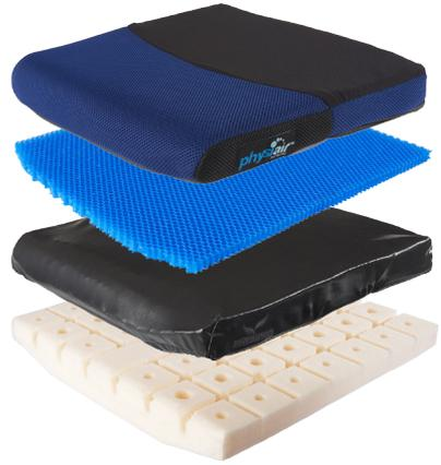
Le coussin Physiair est conçu d'une mousse polyuréthane haute résilience. La mousse est rainurée sur la moitié de l'épaisseur du coussin créant ainsi des cubes qui se comportent comme des ressorts. Cela permet aux cellules de fonctionner individuellement et d'épouser les formes de votre corps.
