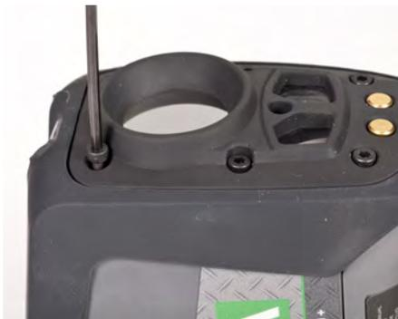
Fig. 17 Support de l'objectif en germanium, vis à enlever
