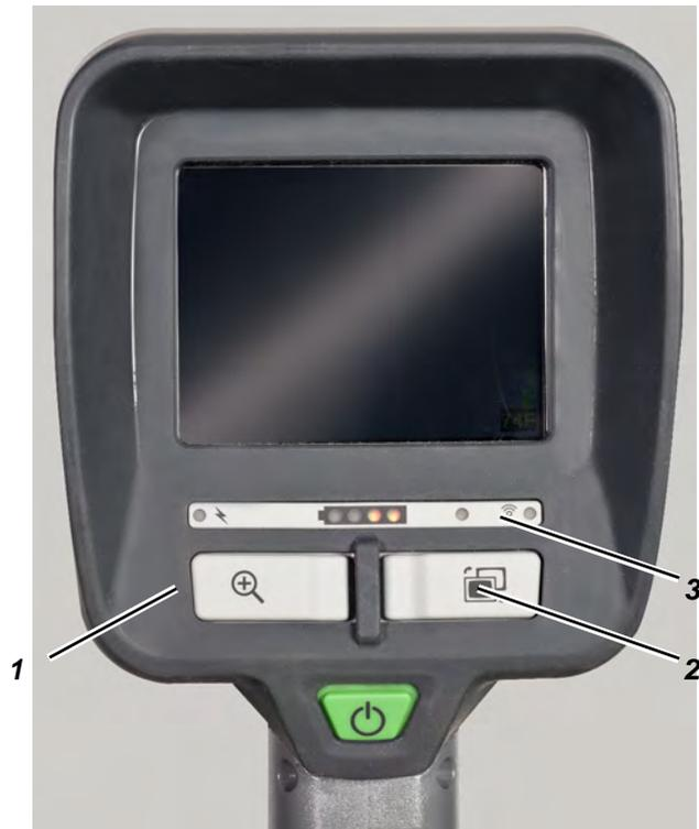
Fig. 7 Boutons supplémentaires des caméras thermiques EVOLUTION 6000+ et 6000 X
