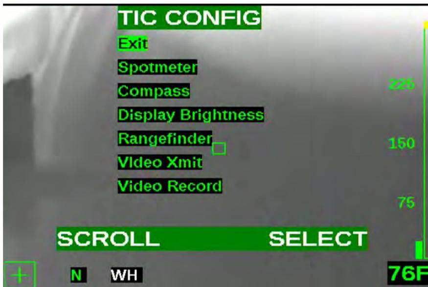
Fig. 13 Menu de configuration (caméras thermiques EVOLUTION 6000+ et 6000X uniquement)
