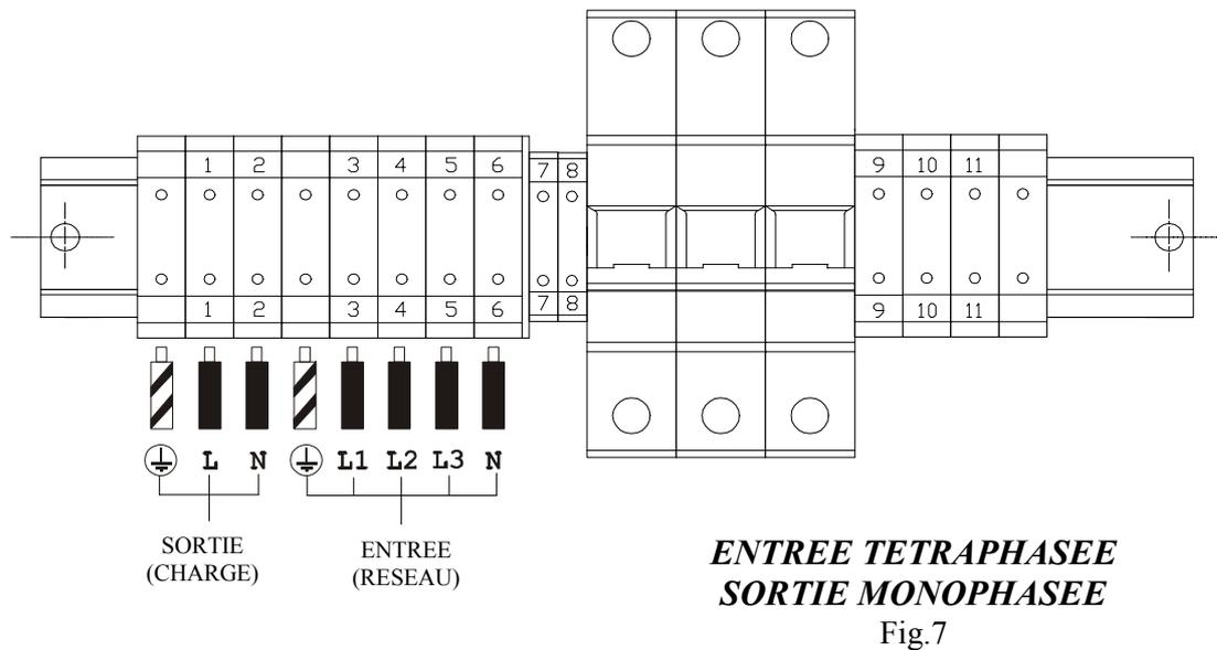
**ATTENTION:** En fonctionnement by-pass (automatique ou manuel) la charge est alimentée directement par le secteur au moyen de la ligne L1. Toutefois la ligne devra être dimensionnée de façon à alimenter toute la charge en sortie à l'onduleur.
