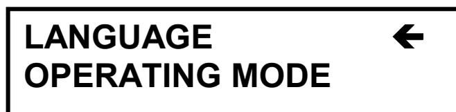
Le menu affiché est le menu principal et l'on peut le consulter en utilisant les touches de défilement. Pour dérouler les sous-menus, il suffit d'aligner le menu d'intérêt au symbole ← et presser la touche ENTER. Par exemple, dans la figure précédente, en pressant la touche de sélection (ENTER) on descend dans le sous-menu LANGUE où l'on peut établir la langue d'affichage des informations sur l'afficheur.
