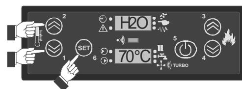
Réglage température pression de l'installation
