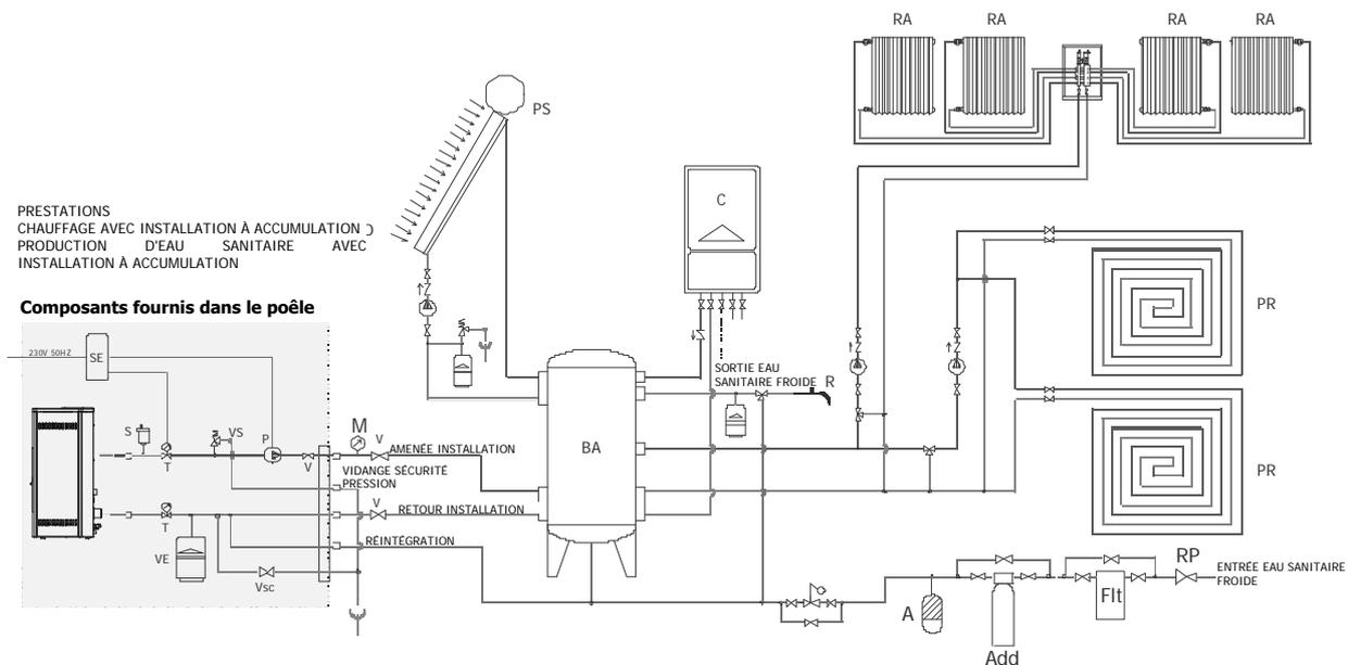
CONFIGURATION : ALPEA KIT SANITAIRE ASSOCIÉ À UNE INSTALLATION À ACCUMULATION AVEC CHAUDIÈRE ET PANNEAUX SOLAIRES
