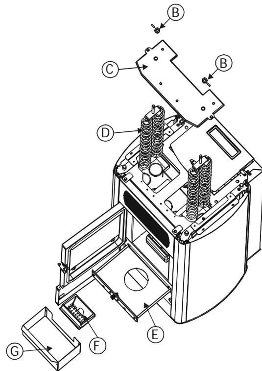
Figure 8 – Nettoyage du faisceau tubulaire, des turbulateurs et du compartiment inférieur (ALPEA)
