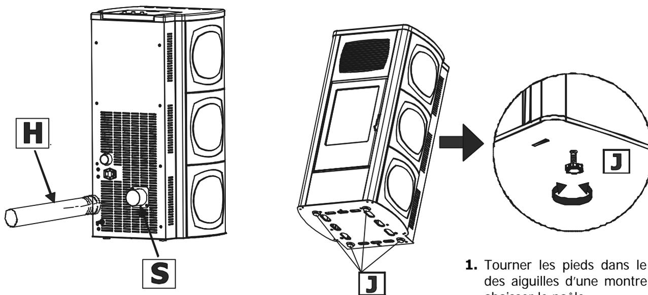
1. Tourner les pieds dans le sens des aiguilles d'une montre pour abaisser le poêle
