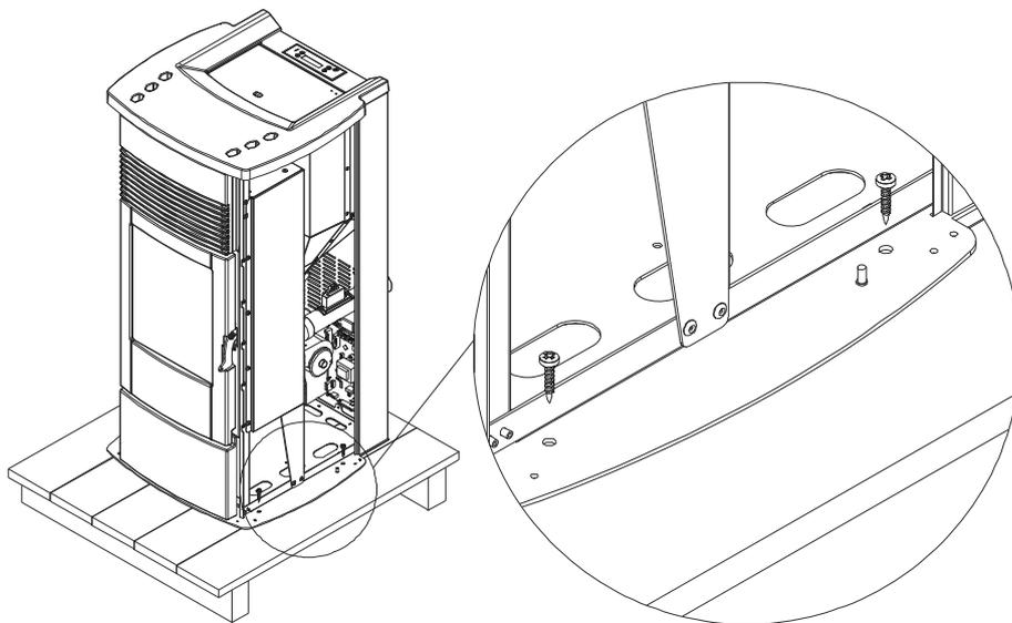
Figure 2 - Extraction des vis de l'emballage
