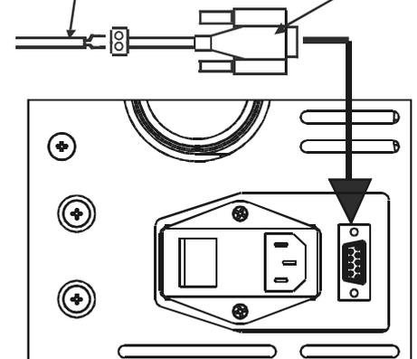
Figure 4 - Raccordement du connecteur série du thermostat externe dans la prise prévue à cet effet placée à l'arrière du poêle
