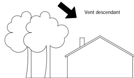
En dehors de la direction et la force du vent, la position du conduit de fumée et de la sortie de toit par rapport au toit de la maison et au paysage environnant, est également importante.
