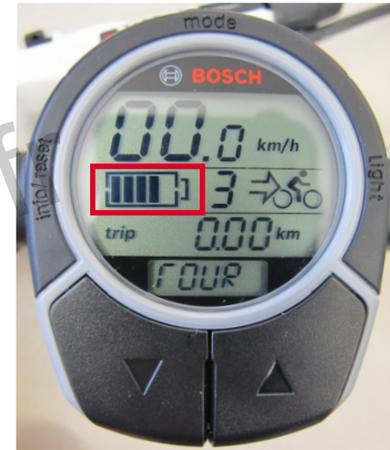
Si la batterie est « vide », l'unité d'entraînement ne donne plus de puissance d'assistance. (il y a une sécurité de 2h de charge pour l'éclairage du vélo)
