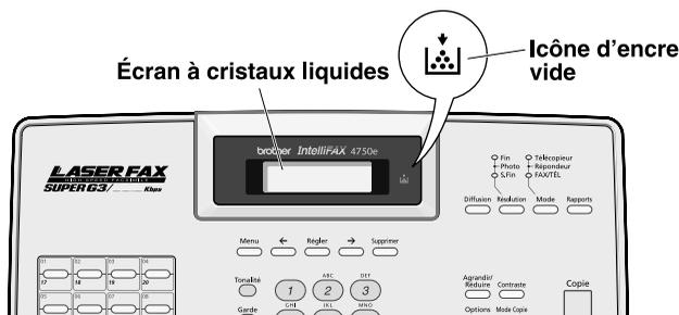
L'icône d'encre vide apparaît et l'écran affiche **ENCRE VIDE** pour indiquer qu'il n'y a plus d'encre. Si ce message apparaît, l'appareil ne reprendra l'impression que lorsque vous aurez installé une nouvelle cartouche.
