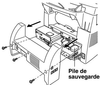
**3** Enlevez les vis fixant la plaque d'accès et déposez la plaque.
