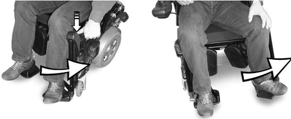
Déverrouiller le repose-jambes et le faire pivoter vers l'extérieur.
