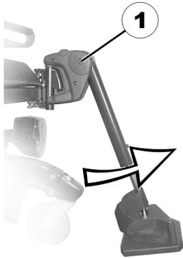
3. Desserrer la vis (1) avec la clé mâle coudée pour vis à six pans creux et faire pivoter le repose-pieds vers le haut pour parvenir au tampon en caoutchouc.
