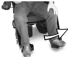
Déverrouiller le repose-jambes et le faire pivoter vers l'extérieur.
