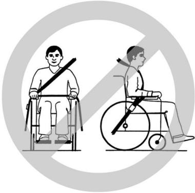
La ceinture de sécurité ne doit pas être éloignée du corps de l'utilisateur par des pièces du fauteuil roulant telles que des accoudoirs ou des roues.
