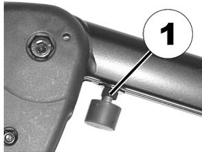
Utiliser la clé plate pour desserrer le contre-écrou (1).
