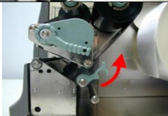
6. Insérer la bande d'étiquette entre les deux axes de guidage puis sous la cellule photo sensible, jusqu'à la règle de déchirement.
