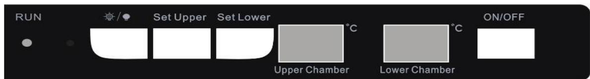
2. Réglez la température en pressant les boutons « Set upper » (plus chaud) et « Set Lower » (plus froid). Chaque pression sur l'appareil fera varier la température réglée de 1 degré. La température sélectionnée clignotera sur le petit écran pendant environ 5 secondes puis affichera à nouveau la température à l'intérieur de l'appareil.
