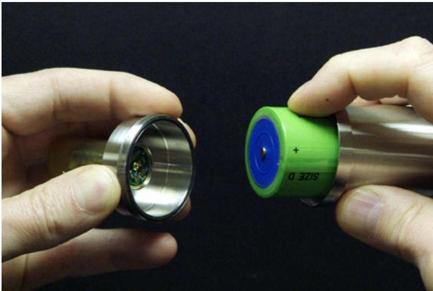
4. Vérifiez que le joint torique est bien en place et intact sur le côté circuit du Répéteur.
