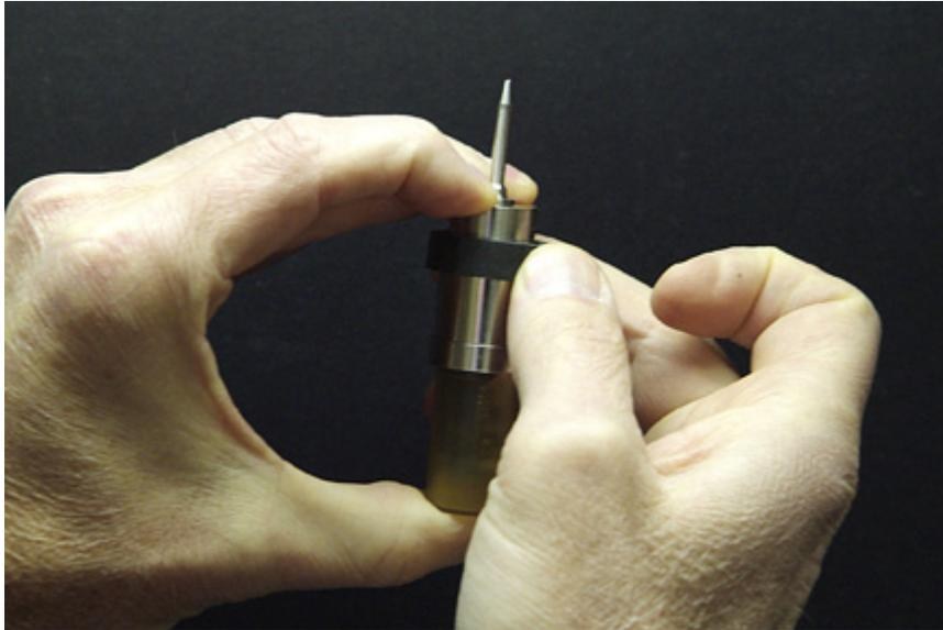
4. Une fois que l'anneau est détaché, retirez-le en le faisant glisser par-dessus le capteur et repoussez délicatement le capteur sur le côté pour accéder à la pile. Pour enlever la pile usagée, saisissez-la et retirez-la en faisant tourner le boîtier jusqu'à ce qu'elle tombe.
