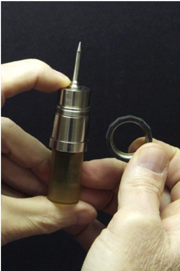
14. Attendez environ 20 secondes après le réassemblage du Tracer et l'installation d'une nouvelle pile avant d'essayer de communiquer avec le Tracer. Ceci permet au circuit de
