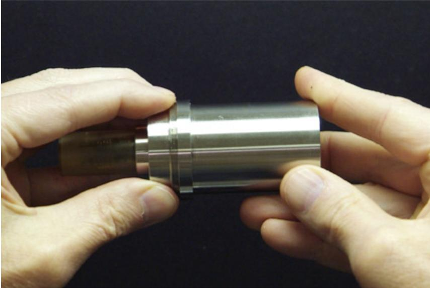
3. Une fois que le couvercle de la pile est détaché, retirez la pile usagée et débarrassez-vous de la pile conformément à la réglementation locale. **N'ESSAYEZ PAS DE RECHARGER, DE DEMONTER OU D'INCINERER LA PILE.**
