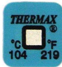
**Figure 5.18.** Autocollant irréversible – état normal, la température n'a pas dépassé la limite – 104°C;
