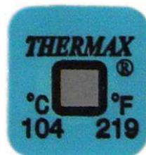
**Figure 5.19.** Autocollant irréversible – état d'urgence, la température a dépassé la limite – 104°C;
