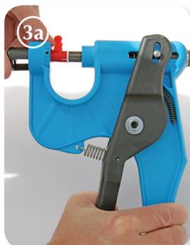
3a. Pressez soigneusement les poignées des pinces jusqu'à l'arrêt complet du grand piston, au niveau de la pièce de liaison rouge.
