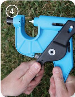
4. Enlevez l'aiguille usagée de la pince en séparant les poignées, ce qui desserrera l'aiguille et la rendra facilement détachable. L'aiguille ne peut plus être utilisée puisqu'elle ne contient plus le piston rouge.
