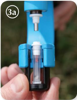
3a. Détachez le tube TSU des pinces en ouvrant l'anneau de rétention et en faisant coulisser le tube.
