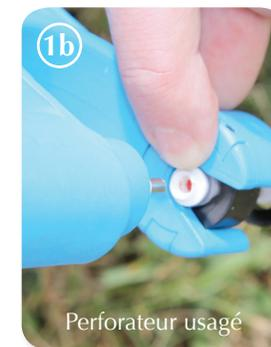
Sur le kit usagé, un témoin ROUGE est visible. Il indique que le tube contient déjà un échantillon et ne peut pas être réutilisé.
