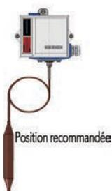
**IMPÉRATIF :** L'implantation des sondes thermostatiques doit être orientée vers le bas avec sortie du capillaire vers le haut.
