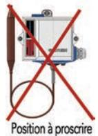
Par construction, le remplissage de nos thermostats permet d'admettre une inclinaison de la sonde de 45° sans effet sur le fonctionnement au-delà, tout dépend de la valeur de la température mesurée par rapport à la température ambiante.
