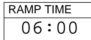
Le temps de rampe doit être suffisamment long pour pouvoir chauffer l'échantillon doucement.
