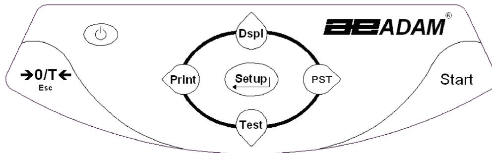
Le clavier possède des touches pour des fonctions secondaires qui permettent de sélectionner un élément du menu ou de modifier ou d'incrémenter une valeur. Droite/Gauche pour changer le chiffre actif et haut/bas pour incrémenter ou décrémenter une valeur.
