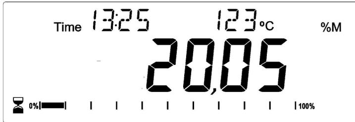
Affiche un test à 13h25, avec la température actuelle de 123°C et 20.05% d'humidité, le test est encore en cours.
