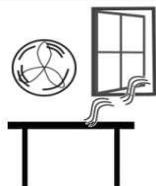
Ne pas placer près de fenêtres ouvertes, de bouches d'air conditionnées ou de ventilateurs qui pourraient causer un courant d'air et des lectures instables.
