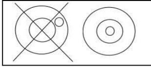
Après avoir placé l'analyseur dans un endroit qui convient, mettez-le de niveau en utilisant le niveau à bulle à l'arrière de celui-ci. Pour mettre à niveau l'analyseur, tournez les deux pieds réglables à l'arrière de l'analyseur jusqu'à ce que la bulle soit au centre du niveau.
