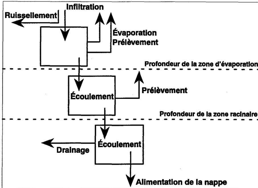
Figure 22. Modèle par réservoirs
