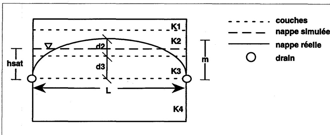
Figure 23. Schéma du drainage
