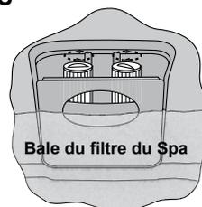
Lors de l'utilisation du spa ou d'un cycle de filtration automatique, l'eau s'écoule à travers l'écumoire du spa et dans les cartouches de filtre à tamis pour bloquer les particules suspendues et les huiles sur les plis de leur surface. Pour conserver une qualité de filtration adéquate, il sera généralement nécessaire de retirer et nettoyer les deux cartouches de filtre une fois par mois ou plus tôt selon l'utilisation du spa et la qualité de l'eau.
