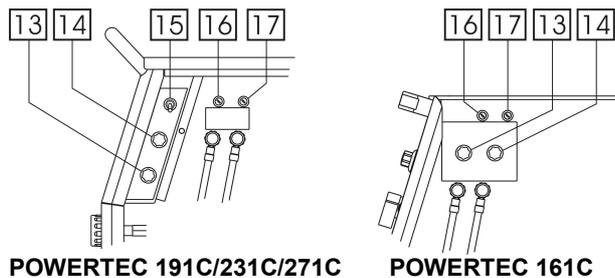
13. Bouton de réglage du temps en mode soudage par point: Le temps de soudage en mode soudage par point est réglable de 0,2 à 8 s.
