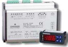
Le régulateur type EC3-332 est prévue pour les applications frigorifiques de chambres froides avec pilote d'une vanne de détente électronique à moteur pas à pas tel les modèles EX4...EX8. Le EC3-332 contrôle la température ambiante de la chambre ainsi que les cycles de dégivrages et le (s) ventilateur (s).
