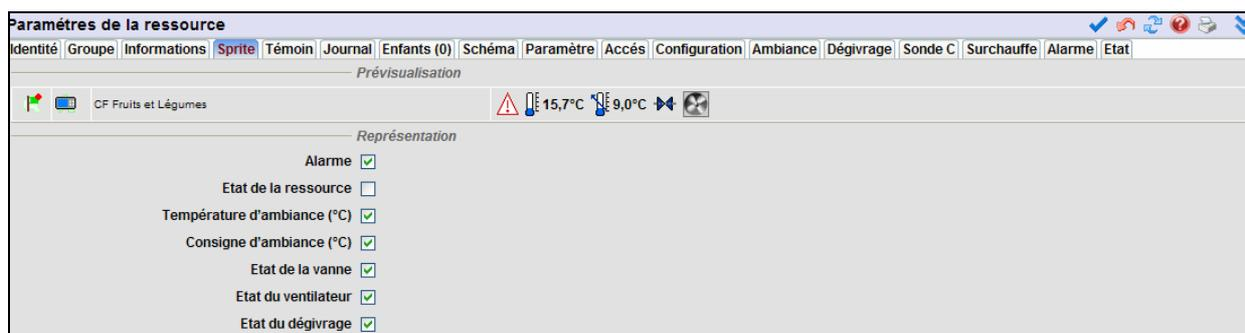
Ce menu permet de sélectionner pour chaque module les éléments à visualiser sous forme d'animations dans le menu Etat, en exploitation.
