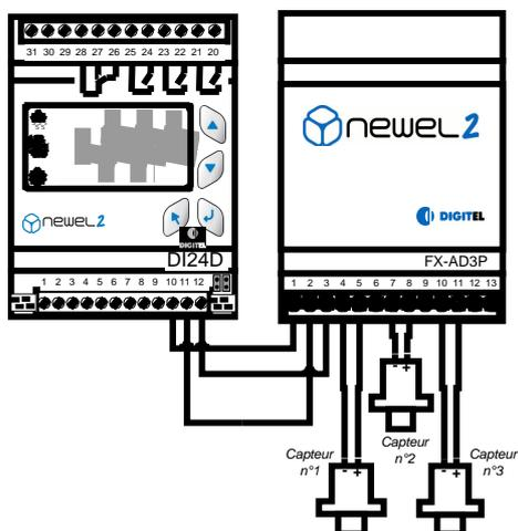
Lorsque le nombre de circuit est supérieur à 3, plusieurs modules FX-AD3P (ICE508) peuvent être cascades afin de pouvoir raccorder le nombre de capteurs nécessaires.
