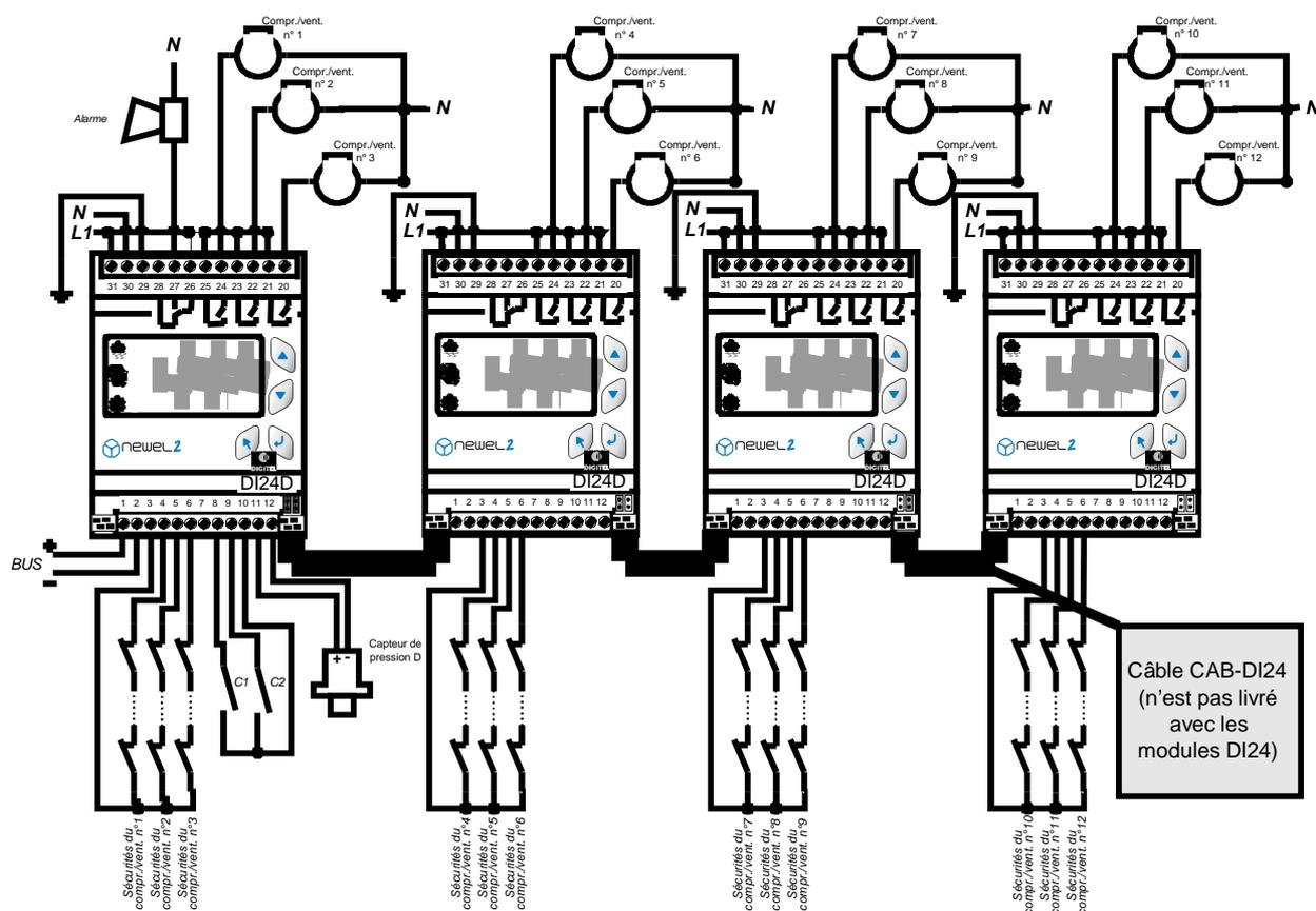
Le DI24E ne peut contenir plus de 3 étages de puissance. Au-delà, il faut utiliser le DI24D avec le schéma ci-dessus.
