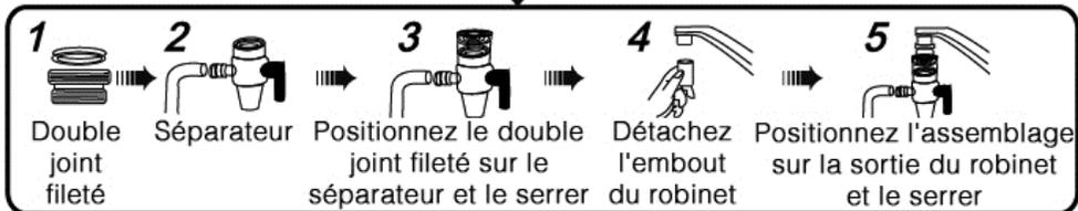
S'il n'y a pas de filetage externe sur le robinet (figure 2, à droite), l'installation est comme suit : Il suffit de retirer l'embout du robinet et de fixer la valve.
