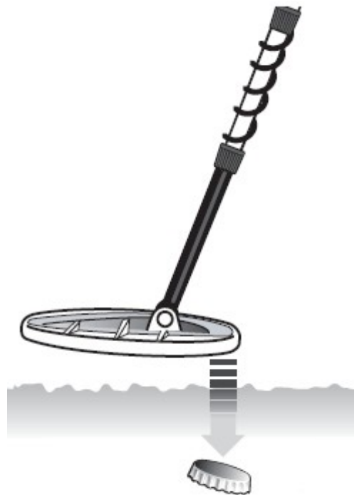
Utilisation du bord arrière du disque du détecteur : une tonalité grave indique une capsule
