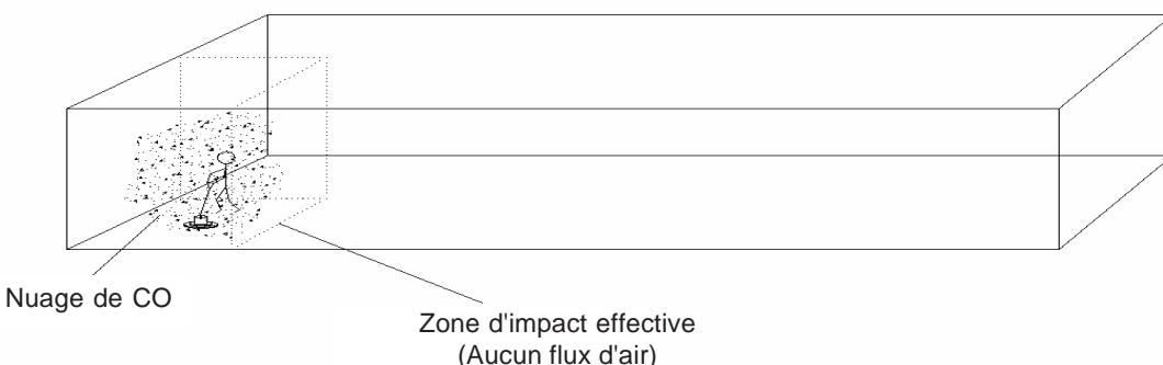
Le décapage est une opération assez différente du polissage, et comporte plus de risques appréciables, puisque le décapage implique un mouvement lent comparé au polissage (surface au sol réduite pour un même temps donné). Comme présenté sur le modèle 1, les concentrations en CO augmentent beaucoup plus rapidement lorsque la « zone d'impact effective » est très réduite comparée à la taille totale du bâtiment.
