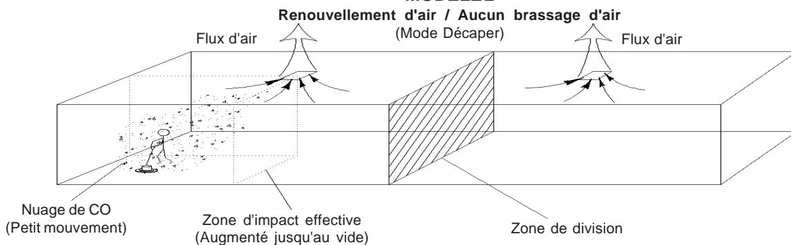
Veuillez observer la concentration en CO et la zone d'impact effective avec le renouvellement d'air. Le nuage de CO est encore concentré en une zone réduite. Veuillez noter la "zone de division" présentées ci-dessus, il s'agit de la ligne au niveau de laquelle le flux d'air change de direction. Dans le modè le 2, les changements d'air sont divisés en deux puisque peu ou pas de CO ne traverse la zone de division pour ê tre déchargé.
