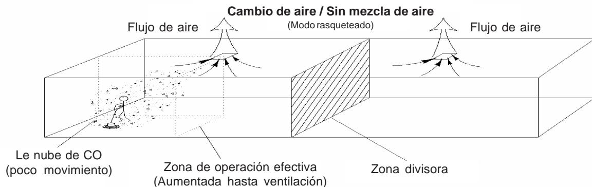
Observe la concentración de CO y la zona de operación efectiva con cambio de aire. La nube de CO sigue concentrada en un área reducida. Observe la “zona divisora” que se muestra arriba, éste es el lugar donde el flujo de aire cambia de dirección. En el Modelo 2, los cambios de aire se reducen a la mitad ya que prácticamente nada de CO cruza la zona divisoria para ser extraído.
