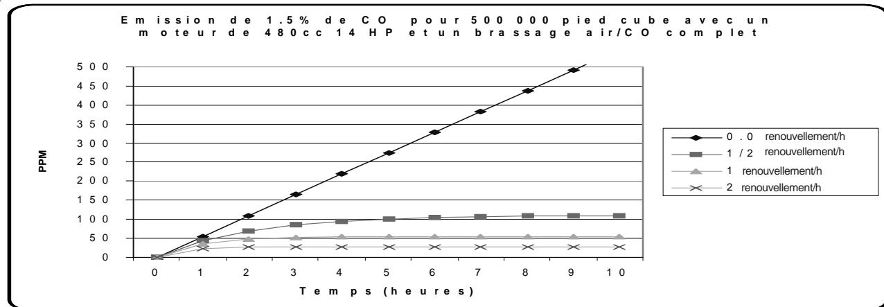
**Le graphique ci-dessus présente la relation renouvellement d'air/temps et le CO en ppm avec la zone en pied par mètre cube et le pourcentage d'émissions de CO demeurant constant.**
