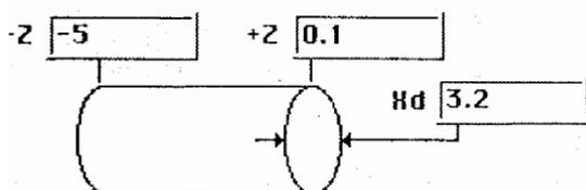
**Fenêtre du brut de tournage:** Cette partie de la fenêtre est utilisée pour déterminer le point de départ du brut. Les dimensions du brut entrées ici seront utilisées par le système pour déterminer les dégagements lorsque l'option *Dégagement auto* est sélectionnée et lorsque l'option *Matière seulement* est sélectionnée pour les passe-outils. Si un brut de
