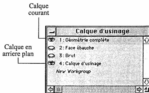
**Sélection d'un calque d'usinage :** La fenêtre de sélection d'un calque d'usinage est utilisée pour créer des calques, passer d'un calque à l'autre et sélectionner des calques afin de les mettre en arrière-plan. Le calque courant est en jaune. Double-cliquer sur un oeil changera la visibilité d'un calque en arrière-plan. La géométrie en arrière-plan sera représentée en gris, et ne pourra pas être éditée ou sélectionnée pour un usinage. Pour sélectionner plusieurs calques afin
