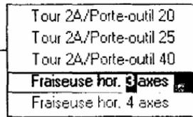
**Type de machine:** Cliquer sur le menu déroulant *Type de Machine* fera apparaître la liste des machines disponibles de votre système. Le choix dépend du ou des modules installés dans votre ordinateur. Il y a soit des fraiseuses verticales soit horizontales. La dimension du porte-outil pour les tours se réfère au standard des portes-outil d'un tour. Ces dimensions de
