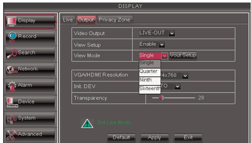
3. Sous le **Mode de visionnement**, sélectionner le mode de visionnement souhaité: **Simple**, **Quadruple**, **Neuf**, ou **Seize**.
