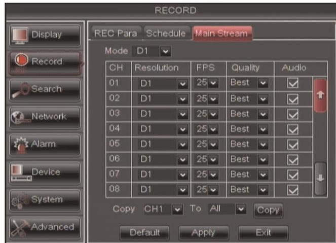
2. À côté du canal correspondant, sélectionnez ou désélectionnez la case sous **Audio** pour activer ou désactiver l'enregistrement audio.
