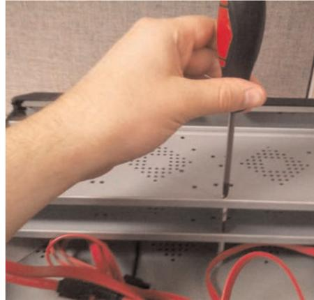
2. Faites glisser l'arrière de la plaque supérieure du disque dur et soulevez-la pour la retirer du DVR.
