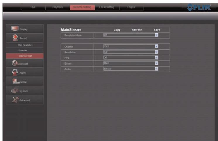
2. Sous **Mode de résolution**, choisir **D1** ou **960H**. Si vous ne disposez pas de caméras compatibles 960H, il est recommandé de sélectionner D1, car cette fonction vous offre un plus grand nombre d'images par seconde (IPS) pour enregistrement. Si le réglage du mode de résolution est changé, le système redémarrera une fois que les modifications seront sauvegardées.
