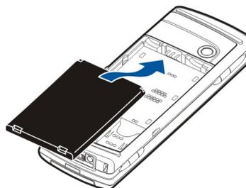
4. Placez les taquets de verrouillage de la façade arrière dans les emplacements prévus à cet effet, et faites glisser la façade pour la mettre en place.
