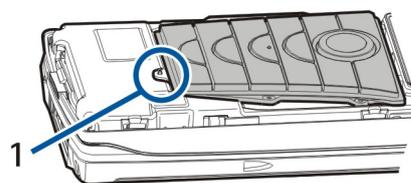
4. Pour remettre en place le tapis du clavier, alignez-le avec le petit taquet et appuyez sur le tapis.
