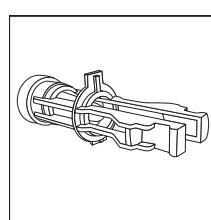
**5** Pour remettre le filtre en place, ou installer un nouveau filtre, s'assurer d'abord que le filtre est correctement orienté avec la languette en plastique dirigée vers le haut. Si le filtre n'est pas correctement orienté, la languette saillante empêchera le filtre de glisser jusqu'à son emplacement initial.
