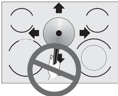
Le frottement d'ustensiles à fond recouvert de cuivre ou d'aluminium peut entraîner des marques de métal sur la surface de la table de cuisson. Ces marques doivent être enlevées **immédiatement** une fois que la table de cuisson a refroidi, en utilisant la crème de nettoyage. Les marques de métal peuvent devenir permanentes si elles ne sont pas retirées avant d'utiliser à nouveau la table de cuisson.
