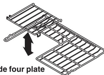
Votre appareil peut être muni d'une ou de plusieurs grilles de four parmi celles illustrées; **grille de four plate avec poignée** recouverte d'émail (Figure 1) ou une **demi-grille de four plate** recouverte d'émail (figure 2). La **demi-grille de four plate** possède une pièce amovible qui procure davantage d'espace pour les aliments plus gros. La partie droite de la demi-grille peut quand même être utilisée pour d'autres aliments comme un plat en cocotte (figure 3).
