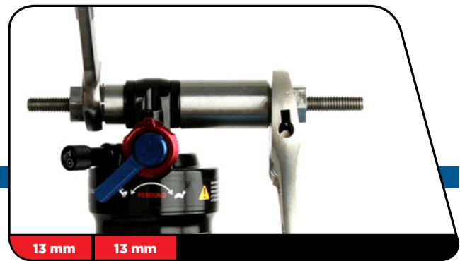
**4** Réinsérez la tige filetée et la clavette de pression à travers l'œillet de la came.
