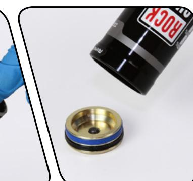
**7** Retirez et remplacez le joint de section carrée du PFI ainsi que la bague de coulissage.
