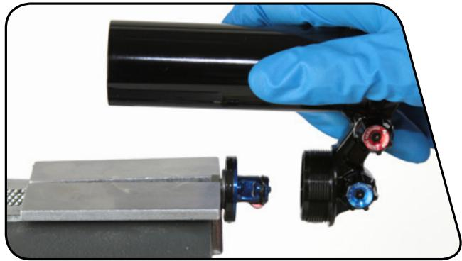
**12** Insérez une clé hexagonale de 2 mm par le côté de l'écrou de la valve de compression pour pousser sur l'aiguille de compression et la faire sortir.
