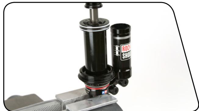
**2** Maintenez la butée de talonnage à distance de la tête d'étanchéité et insérez la clé à ergots RockShox Vivid de 24 mm dans les trous de clavette de la tête d'étanchéité. Tournez la clé à ergots dans le sens inverse des aiguilles d'une montre afin de retirer la tête d'étanchéité du corps de l'amortisseur.
