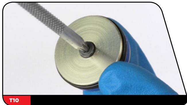
**10** Retirez et remplacez le joint torique de la vis de purge du PFI.
