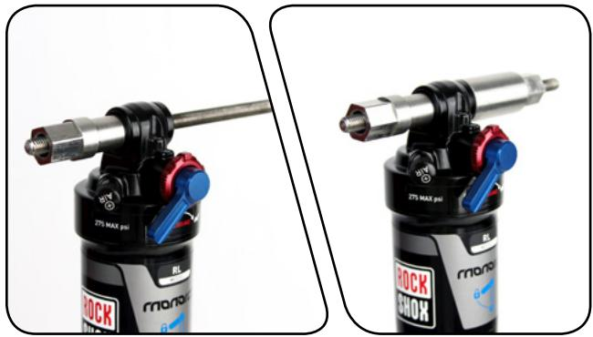
**3** Serrez le receveur dans un étau ou bloquez-le fermement à l'aide d'une clé plate de 13 mm ou d'une clé à molette.
