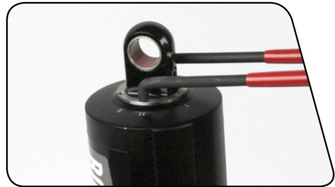
**42** Placez la clé à ergots sur la bague de verrouillage puis serrez l'œillet de la came dans un étau en laissant juste assez de place pour faire tourner la clé à ergots. À l'aide de la clé à ergots, serrez la bague de verrouillage à un couple de 22,6 N•m. Retirez l'amortisseur et la clé à ergots de l'étau.
