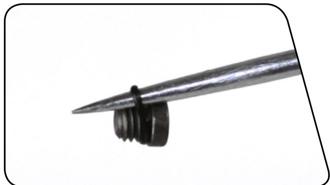
**11** Serrez délicatement l'écrou de la valve de compression dans un étau et tirez sur l'amortisseur pour le retirer de la valve de compression. Retirez la valve de compression de l'étau.
