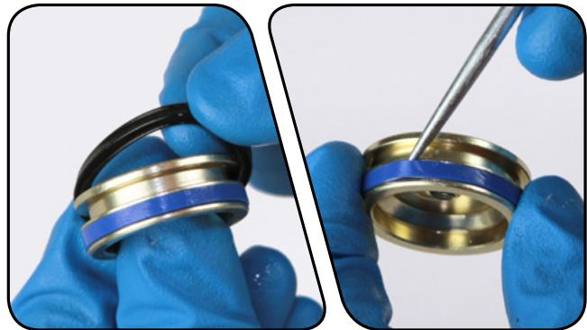
**8** Retirez et remplacez le joint torique du réservoir du PFI et la rondelle d'épaulement située au-dessus du filetage interne du réservoir du PFI.
