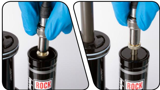
**31** Avec la pompe, mettez le réservoir en pression à 200 psi (14 bar).
