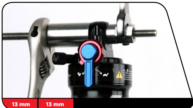
**3** Dévissez le receveur de la tige filetée. Retirez l'outil de l'œillet de la came et jetez la vieille bague.
