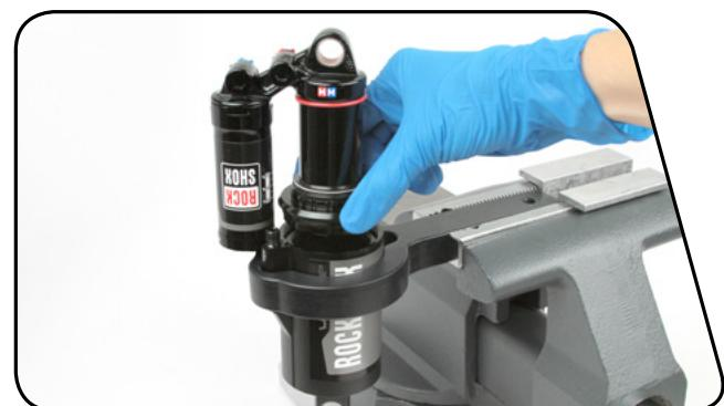
**44** Entourez le corps de l'amortisseur avec du ruban d'électricien. À l'aide de l'outil pour jeu de pédalier, tournez le collier de la cartouche pneumatique dans le sens des aiguilles d'une montre et serrez-le à un couple de 28,2 N•m. Retirez l'amortisseur de la clé pour cartouche pneumatique RockShox Vivid.
