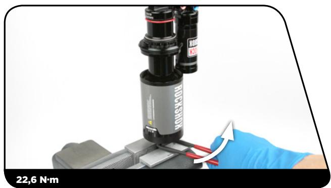
**43** Serrez la clé pour cartouche pneumatique RockShox Vivid dans un étau puis placez la cartouche pneumatique dans la clé. Repoussez le collier de la cartouche pneumatique contre le corps de l'amortisseur et vissez-le dans la cartouche pneumatique.
