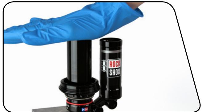
**12** Une fois que la majorité du liquide contenu dans le corps de l'amortisseur est passée dans le réservoir, tapez sur le dessus du réservoir à plusieurs reprises avec la paume de la main pour refaire passer le liquide dans le corps de l'amortisseur. Ceci permet d'enlever encore les bulles d'air présentes dans le circuit.
