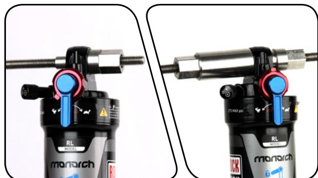
**2** Serrez le receveur dans un étai ou bloquez-le fermement à l'aide d'une clé plate de 13 mm.
