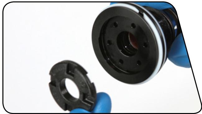
**8** Retirez et remplacez les deux bagues de coulissage de la tête d'étanchéité ainsi que le joint de section carrée.
