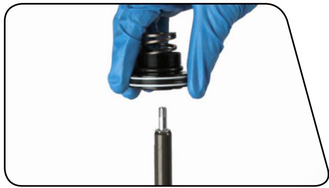
**7** Retirez la butée de talonnage de la tête d'étanchéité.
