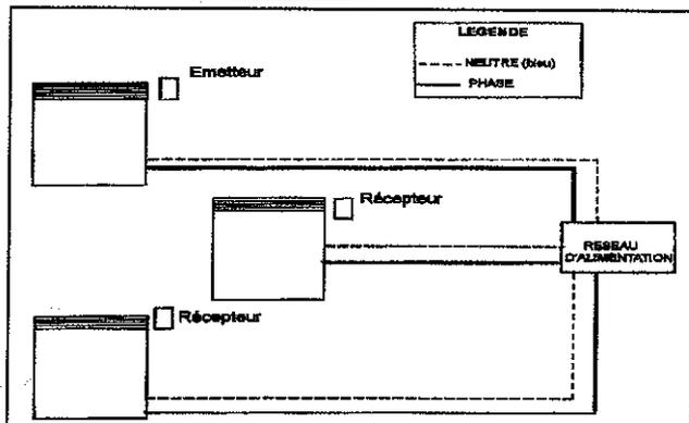
A partir du réseau d'alimentation, on crée une zone de programmation avec 1 émetteur pour plusieurs récepteurs.
