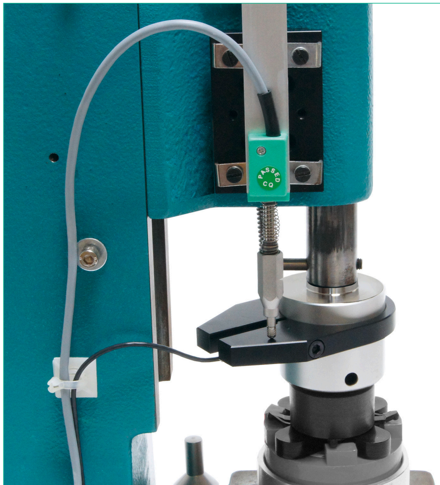
Illustration 1.6 : Système de mesure déplacement (WMS) en position inférieure
