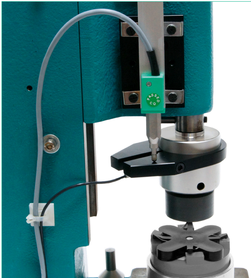
Illustration 1.5 : Système de mesure déplacement (WMS) en position haute
