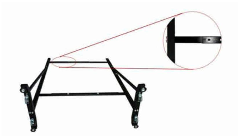
Etape 7. Fixer les fentes en U avec un ensemble de boulon hexagonal B. A cette étape, ne pas visser à fond le boulon pour pouvoir ajuster l'écrou papillon plus tard.
