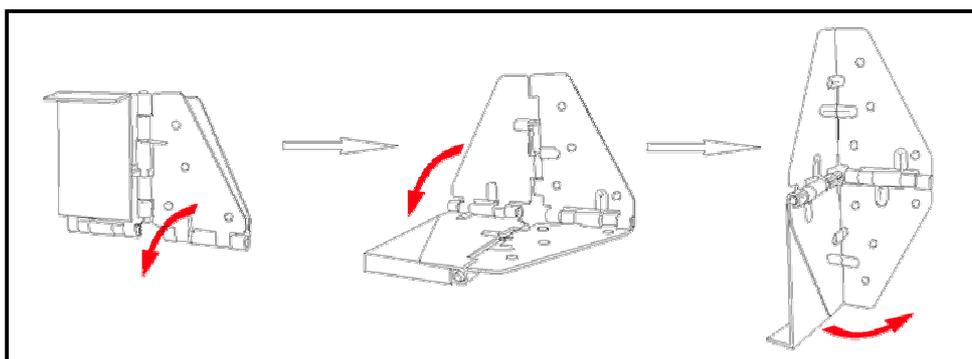
Dévisser l'équerre de fixation murale via les deux vis cruciformes accessibles par le dessus de l'appareil.
