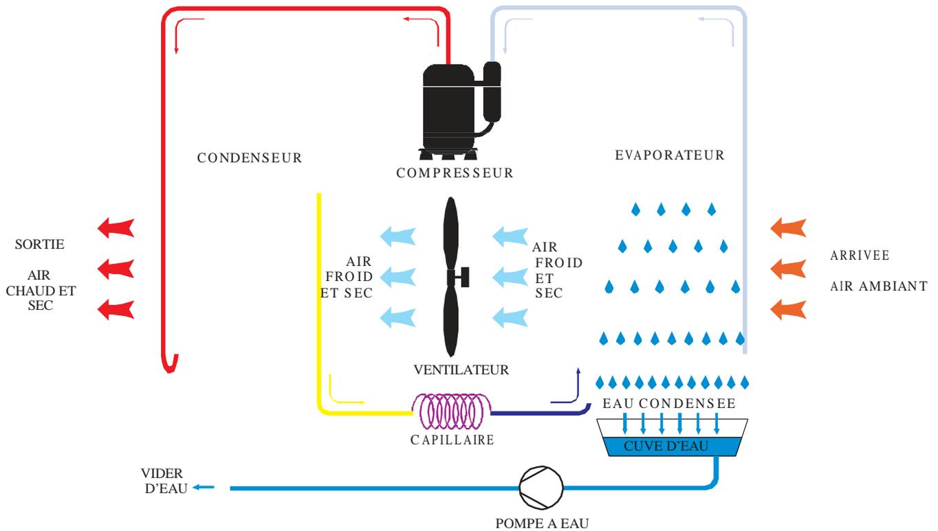
Le déshumidificateur utilise le circuit de réfrigération pour transformer l'air humide en air sec et chaud. Lorsque l'air humide passe dans l'évaporateur, l'eau de l'air se condense et l'air devient sec.
