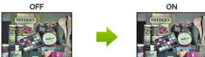
« **HLC** » (High Light Compensation) : compensation de forte luminosité permettant d'identifier et de compenser les zones exposées à une forte lumière provenant d'une source située juste en face de la caméra. Elle noircit les zones exposées à forte lumière pour améliorer l'affichage des détails des zones sous-exposées.
