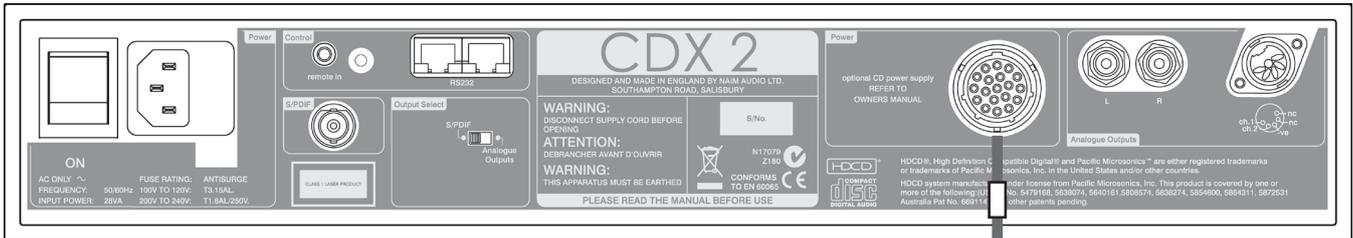
**Note :** En cas d'utilisation d'une alimentation CD 555PS avec un lecteur CDX2, utiliser uniquement la prise de sortie alimentation N° 1.
