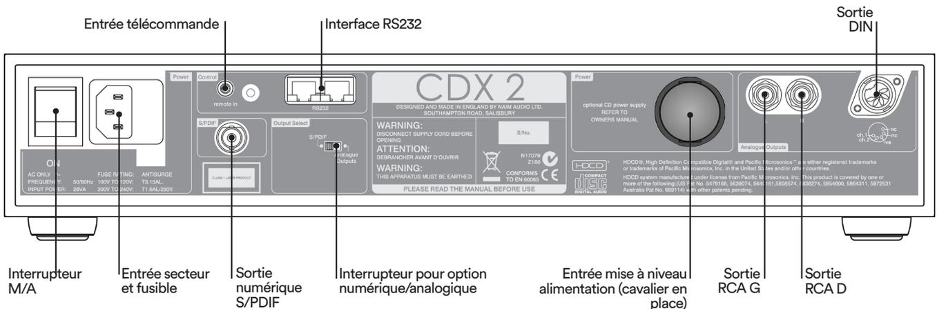
**Note :** Les prises de sorties RCA et DIN ne doivent pas être connectées en même temps.
