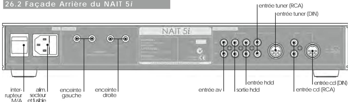
**Note :** Le Nait 5i utilise plusieurs technologies afin de réduire les effets microphoniques. Une certaine mobilité du circuit imprimé et des prises est normale lors du raccordement et du déraccordement des câbles.
