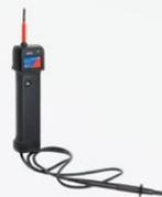
Le CPOL peut contrôler la polarité correcte au niveau des différents points de connexion du câblage secondaire en analysant un signal en dents de scie injecté sur le côté primaire du TT à l'aide du CPC 100.
