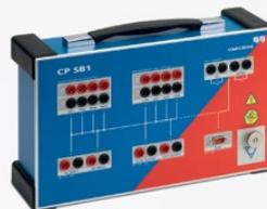
Le boîtier de commutation CP SB1 est le lien entre le transformateur et le CPC 100. La connexion simultanée de toutes les phases permet d'éviter les erreurs de câblage et de monter sur le transformateur à plusieurs reprises. Le contrôle automatique du CPC réduit la durée des tests.
