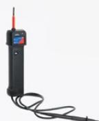
Le CPOL peut contrôler la polarité correcte au niveau des différents points de connexion du câblage secondaire en analysant un signal en dents de scie injecté sur le côté primaire du TC à l'aide du CPC 100.
