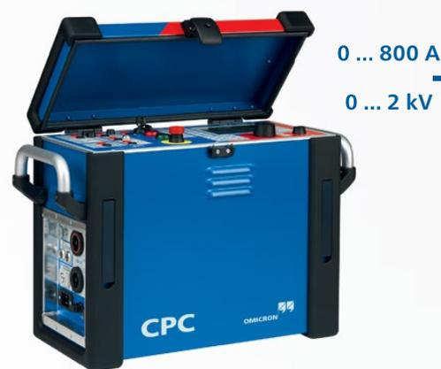
Le CPC 100 peut injecter jusqu'à 800 A (2000 A avec le CP CB2) ou 2 kV ainsi qu'un signal de contrôle de polarité en dents de scie dans les TC ou les TT du réseau HT, réalisant ainsi les tests sur l'ensemble du système.
