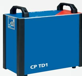
Évaluation de l'état de l'isolement des transformateurs, des traversées et des liquides isolants (avec CP TC12).
