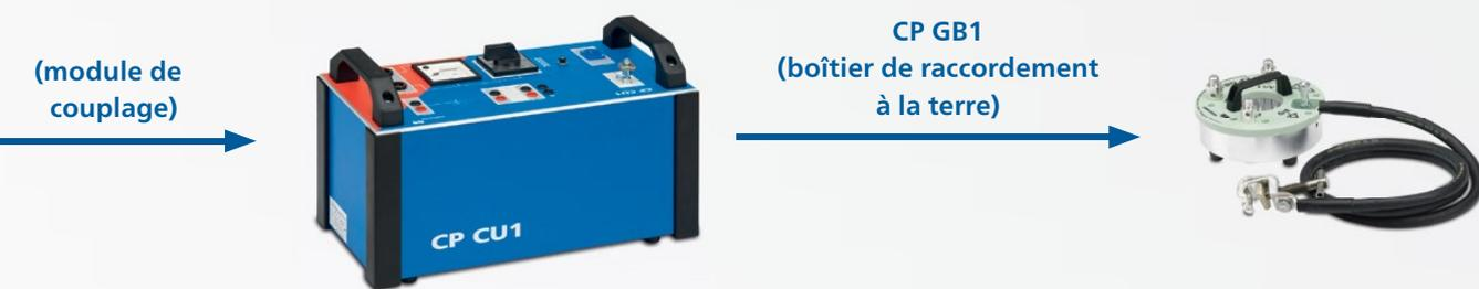
Le CP CU1 permet d'assurer une connexion sécurisée du CPC 100 à une ligne de puissance ou à un câble HT. Le transformateur d'impédance à l'intérieur du CP CU1 garantit un transfert de puissance optimal entre le CPC 100 et la ligne.
