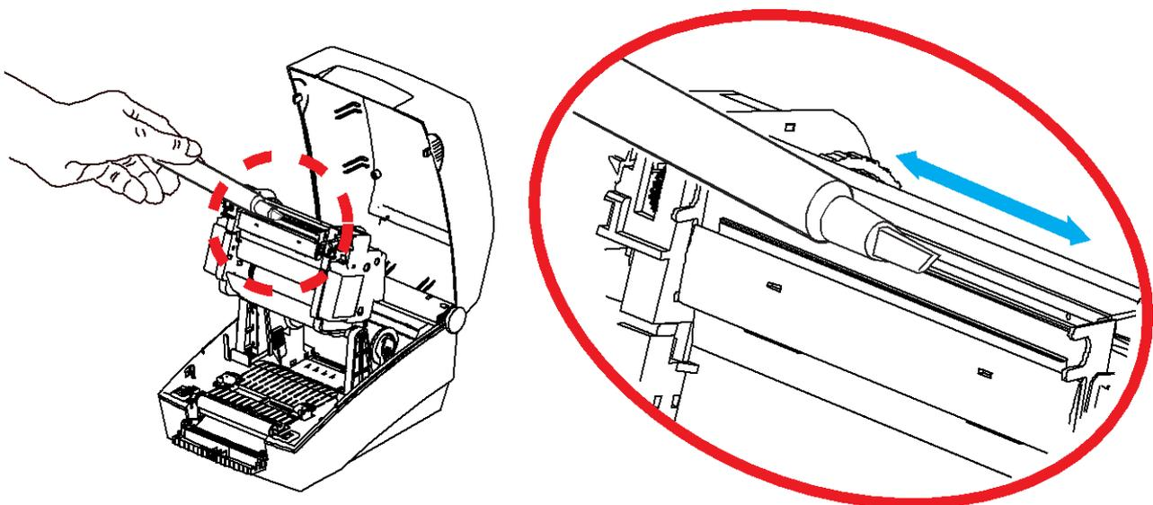
**6-2 Capteurs de nettoyage, rouleau ou/et tracé du papier**
