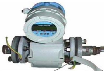
Fig. 8: Vue du débitmètre utilisé
