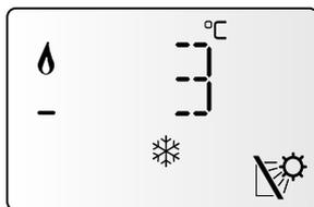
La chaudière est équipée d'un ballon, un second dispositif contrôle la température sanitaire. Si celle-ci devient inférieure à 8°C, la vanne distributrice bascule en position sanitaire et le brûleur s'allume jusqu'à ce que la température atteigne 12°C. Cela est suivi d'une post-circulation de 2 minutes.
