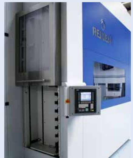
Poste de chargement d'outils
