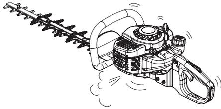
1. Lorsque le moteur démarre, le laisser chauffer au ralenti (c.-à-d. à bas régime) pendant 2 à 3 minutes.
