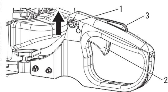
1. Déplacer l'interrupteur marche/arrêt de la position Arrêt.
