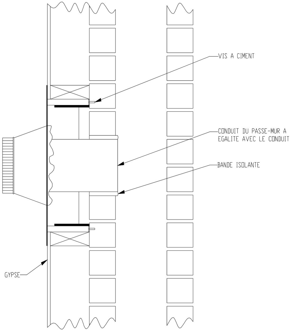
**FIGURE 2.2.2 (B) Passe-mur préfabriqué**
