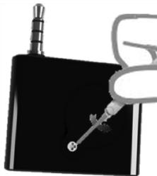
2) Remplacer la pile usagée CR1632 par une nouvelle pile CR1632 et vérifier que le pôle positif (+) de la pile soit bien positionné vers le haut.
