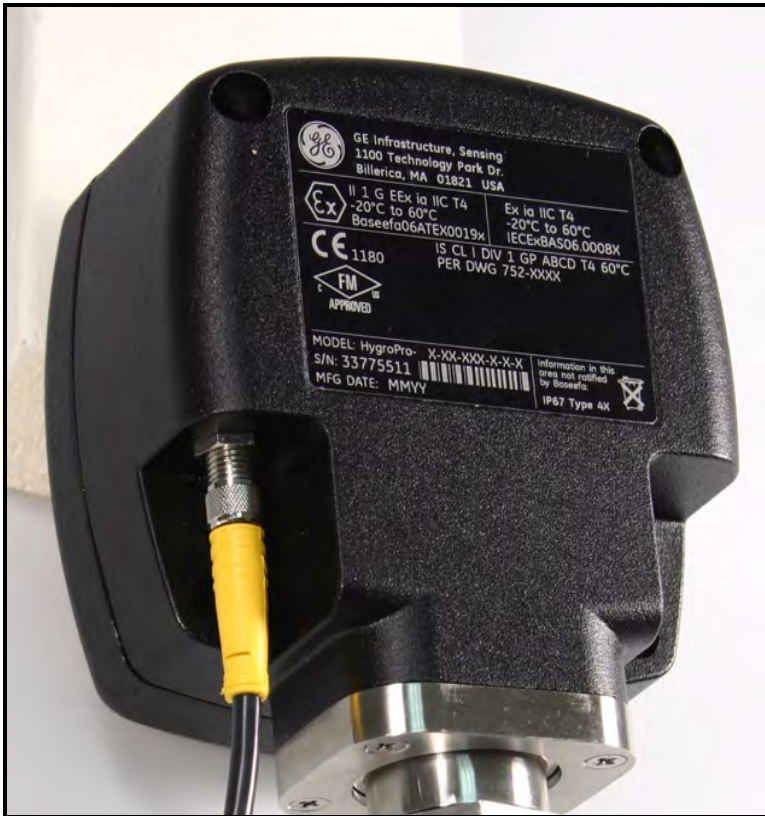
Figure 9 : Étiquette de certification de l'HygroPro - Vue arrière
