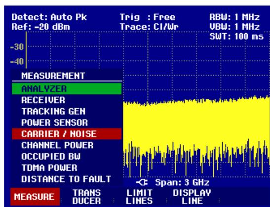
Les réglages des paramètres de mesure les plus importants peuvent être sélectionnés directement dans le menu principal de la mesure Carrier / Noise ; on peut également les entrer à l'aide des touches de fonction correspondantes.
