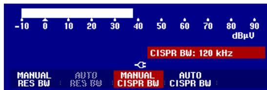
Etant donné que selon CISPR16 les largeurs de bande CISPR dépendent de la fréquence réglée, le R&S FSH effectue un sélectionnement automatique:
