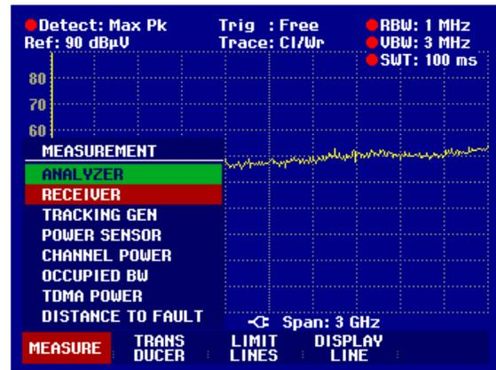
Le R&S FSH active le mode récepteur et mesure le niveau sur la fréquence réglée.
