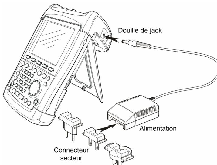
Afin d'allonger la durée de service sur batterie, le R&S FSH est doté d'une coupure automatique de l'alimentation (power down mode) qui s'active si aucune entrée n'est effectuée pendant une durée sélectable (5 ou 30 minutes).
