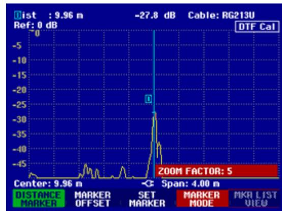
La copie d'écran ci-contre indique que le défaut du câble mesuré comprend deux transitions. En fait, un raccord de 7 cm a été utilisé pour relier deux câbles.
