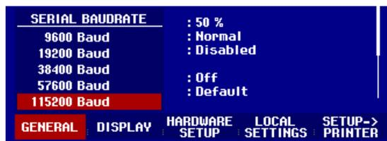
Le R&S FSH indique la vitesse de transmission choisie dans l'affichage Setup, sous l'indication "SERIAL Baudrate".
