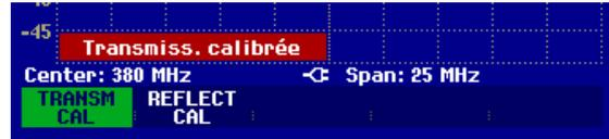
Une fois le calibrage terminé, le R&S FSH affiche **Transmission** en haut à droite du diagramme pour signaler qu'il est calibré pour la mesure de la fonction de transmission. En outre, la touche logicielle TRANSM CAL est sur fond vert.
