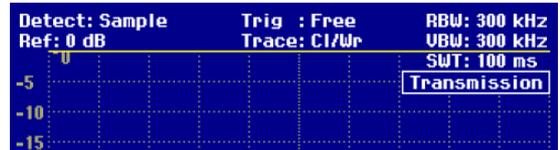
➤ Raccorder l'objet sous essai entre l'entrée RF et la sortie du générateur.
