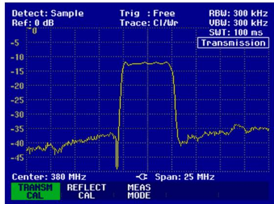
Le calibrage de transmission est conservé jusqu'à la modification de la fréquence centrale ou de la plage de représentation du R&S FSH. En cas de perte du calibrage, **Track Gen Uncal** s'affiche en haut à droite de l'écran.
