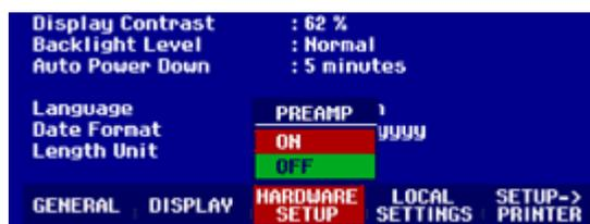
Le R&S FSH passe dans le sous-menu de configuration du préamplificateur. La barre de sélection affiche le réglage instantané.
