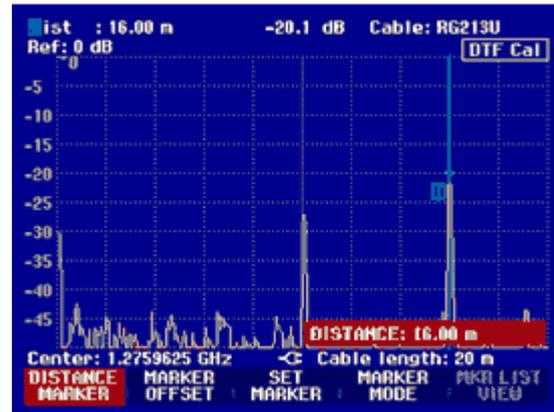
Afin d'obtenir une résolution élevée d'un défaut, le R&S FSH offre une fonction zoom à la position du marqueur. L'axe des x de l'afficheur peut s'agrandir jusqu'à une plage de représentation de 3 mètres.
