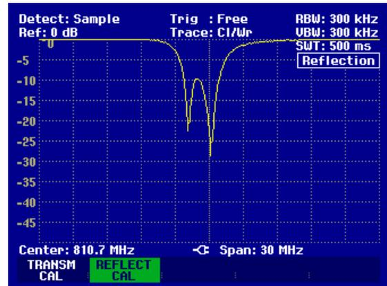
Le calibrage de transmission est conservé jusqu'à la modification de la fréquence centrale ou de la plage de représentation de la fréquence du R&S FSH. En cas de perte du calibrage, Track Gen Uncal s'affiche en haut à droite de l'écran.
