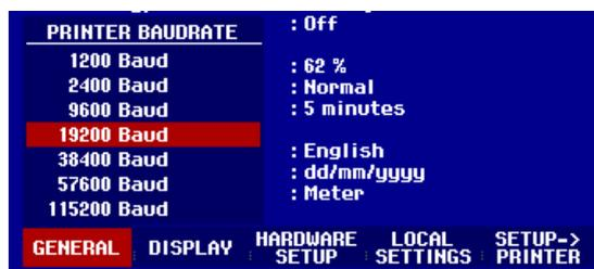
Le R&S FSH affiche la vitesse de transmission choisie, sous "RS232 Baudrate" de la fenêtre Setup.
