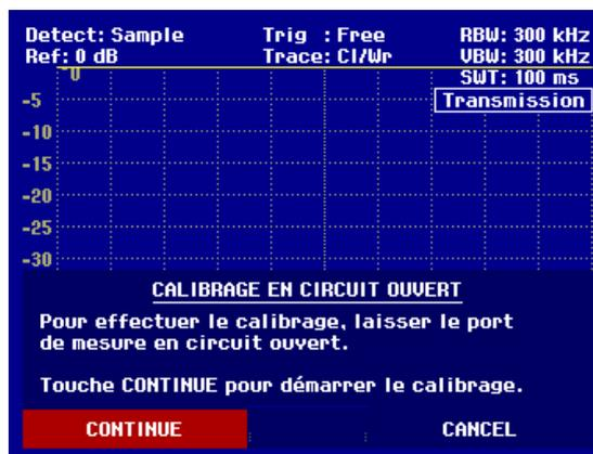
Une fois le calibrage en circuit ouvert terminé, le R&S FSH invite l'utilisateur à effectuer le calibrage en court-circuit.
