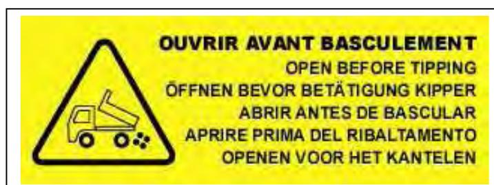
Il est impératif d'ouvrir la ridelle arrière avant de lever la benne pour déversement : risque d'accident corporel et d'endommager la ridelle arrière.
