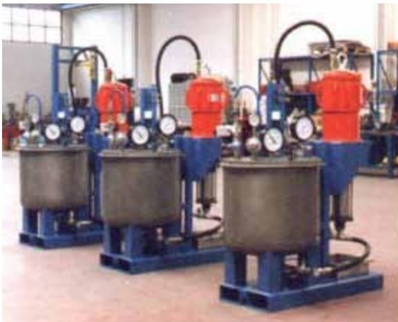
Dans la figure est représenté un exemple typique d'une pompe pneumatique à piston de transvasement LARIUS.
