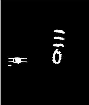
La segmentation correspond à la division de l'image en zones homogènes afin de séparer les divers composants visibles du reste de l'image (bois, taquets...). A cette étape on, les "symboles" et la "contamination lumineuse" (la chaîne du convoyeur qui fait des reflets de lumière sur la gauche de l'image) sont représentés sous forme de "blob".
