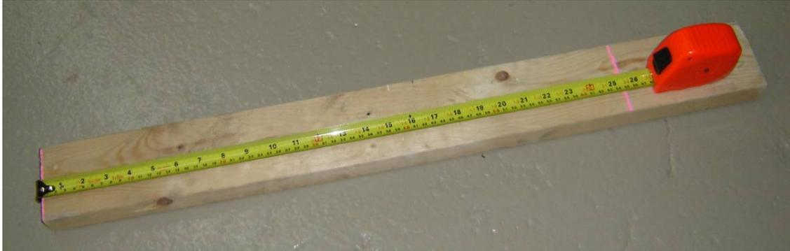
*Figure 24: Réalisation d'une planche étalon*
