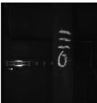
La caméra fait une acquisition de la planche dès qu'un front apparaît sur la phot cellule ou PLC. C'est cette image qui va servir pour le reste du processus.
