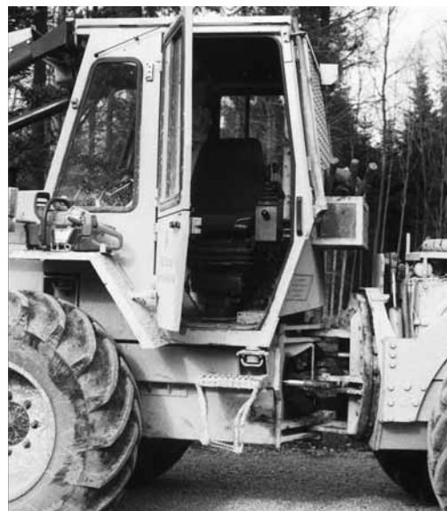
Fig. 2: marchepied antidérapant avec une hauteur de marche correcte et des poignées.
