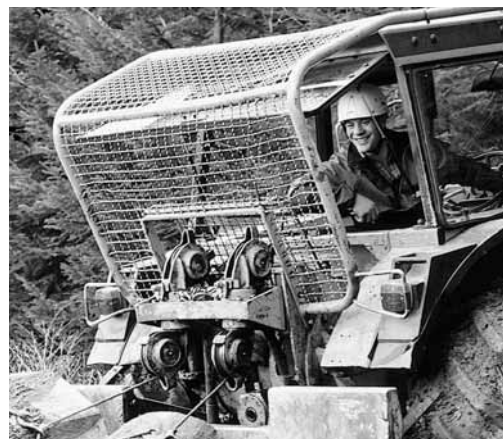
Fig. 1: la cabine protège le conducteur de l'engin contre la pénétration ou la chute d'objets, le préserve du risque d'écrasement en cas de renversement de l'engin ainsi que des influences atmosphériques.
