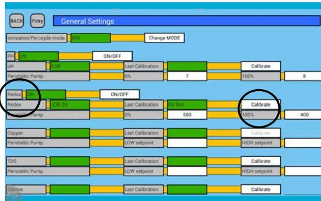
Nous réalisons la même opération que pour le calibrage de la sonde de pH. Nous introduisons la sonde de Redox dans la solution d'étalonnage 468mV. Le système détectera la lecture et procédera au calibrage. Une fois calibrée, il faudra introduire la sonde dans la chambre.
